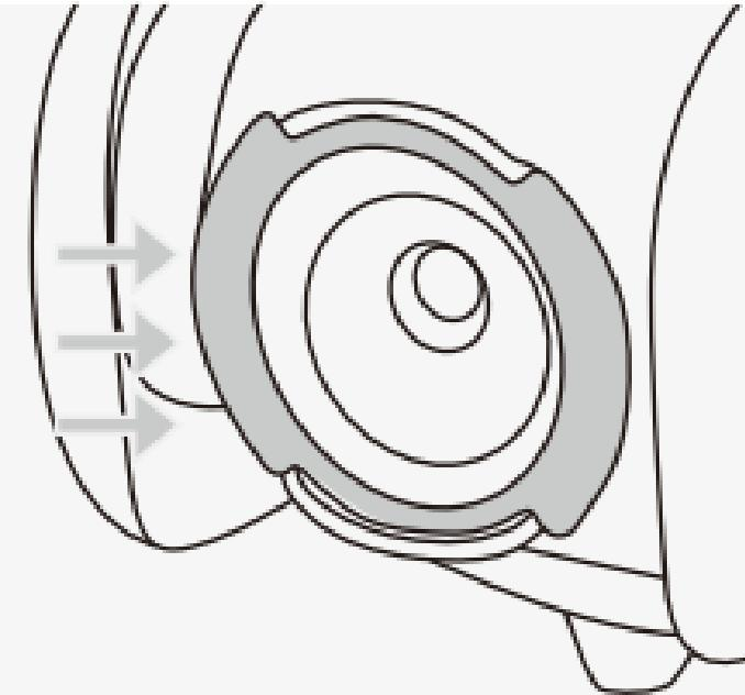
Richten Sie den Magnetring auf die Kamera der Drohne aus, drücken Sie fest, um ihn zu zentrieren und zu sichern, und stellen Sie sicher, dass das Klebeband vollständig haftet, indem Sie beide Seiten andrücken.
