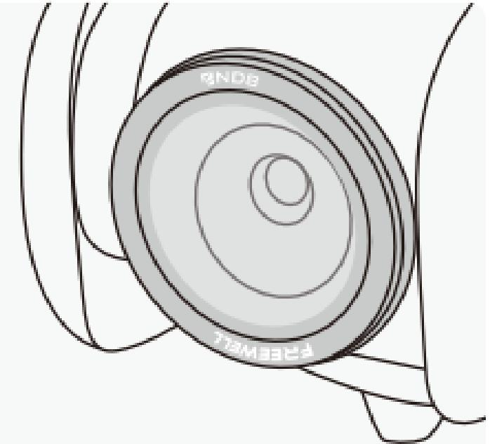
安装完成后，如需更换滤镜，只需卸下当前滤镜并安装新的滤镜即可。磁环保持在原位，您只需更换滤镜而无需卸下磁环。
