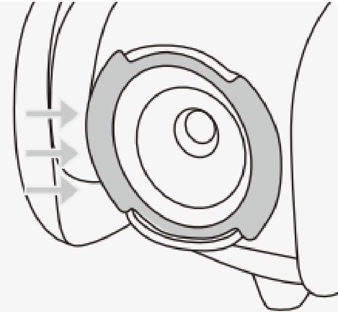
Alignez l'anneau magnétique avec la caméra du drone, appuyez fermement pour le centrer et le fixer, puis assurez-vous que le ruban adhère complètement en appuyant sur les deux côtés.
