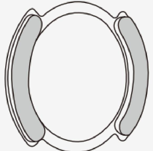
Rimuovi la pellicola protettiva da entrambi i lati dell'anello magnetico per esporre il nastro biadesivo.
