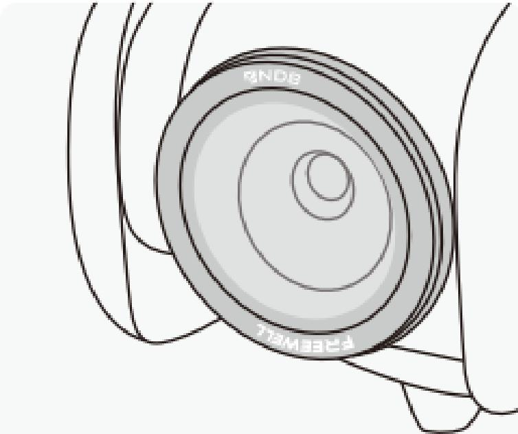
Dopo l'installazione, per sostituire il filtro, basta rimuovere quello attuale e applicarne uno nuovo. L'anello magnetico rimane al suo posto e devi solo sostituire il filtro senza rimuovere l'anello magnetico.
