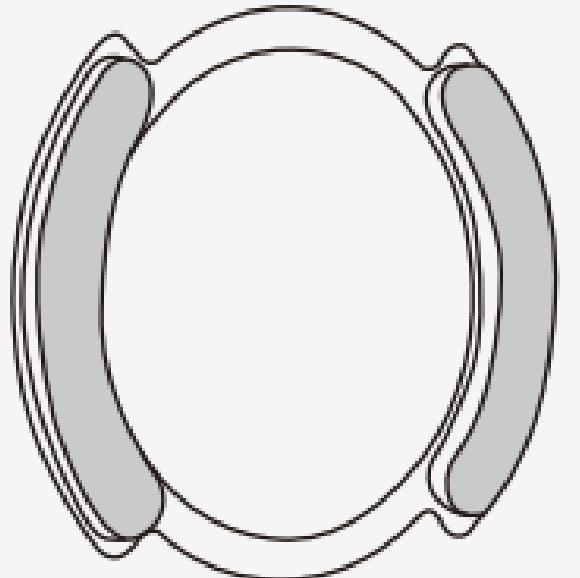
Entfernen Sie die Schutzfolie von beiden Seiten des Magnetrings, um das doppelseitige Klebeband freizulegen.
