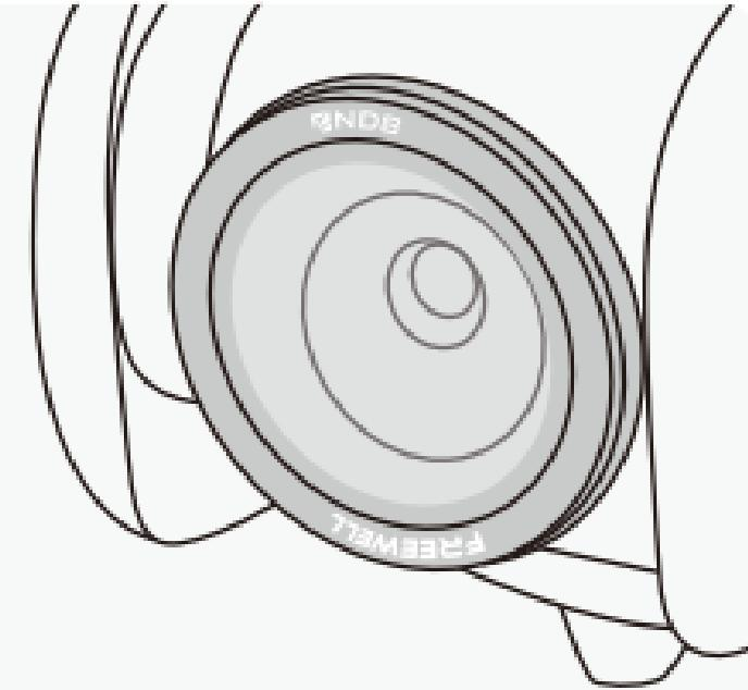
Une fois l'installation terminée, pour remplacer le filtre, retirez simplement le filtre actuel et fixez-en un nouveau. L'anneau magnétique reste en place, il suffit de changer le filtre sans retirer l'anneau magnétique.
