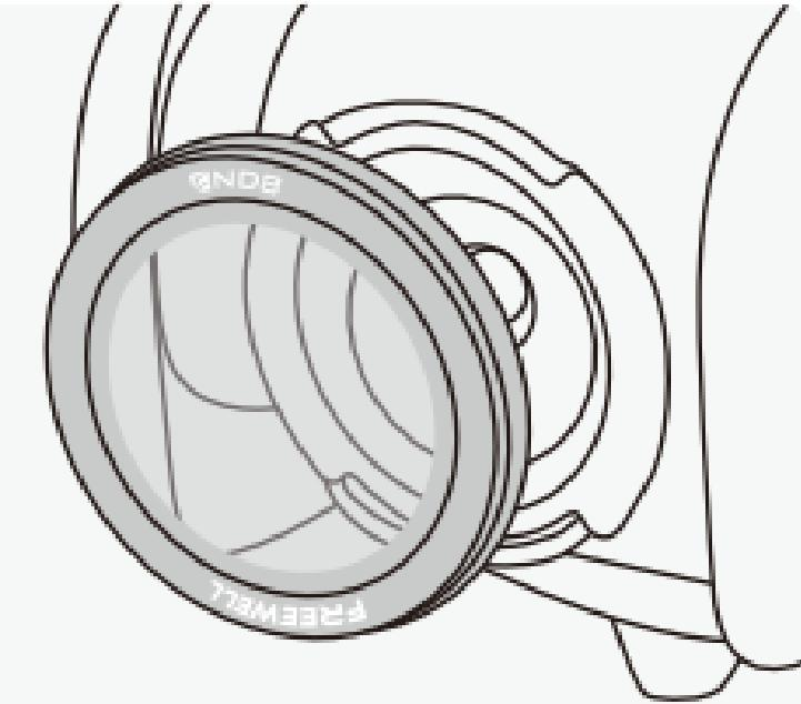
Assurez-vous que le logo et le numéro de modèle sont orientés vers l'extérieur. Alignez l'anneau magnétique avec le type de filtre requis, permettant ainsi au filtre de tourner librement pendant l'utilisation.
