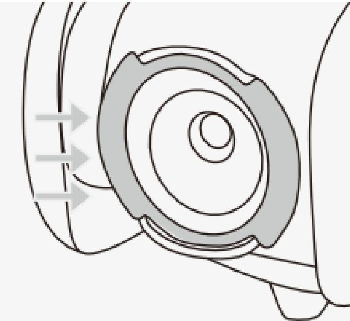
Allinea l'anello magnetico con la fotocamera del drone, premilo saldamente per centrarlo e fissarlo, quindi assicurati che il nastro adesivo completamente premendo entrambi i lati.
