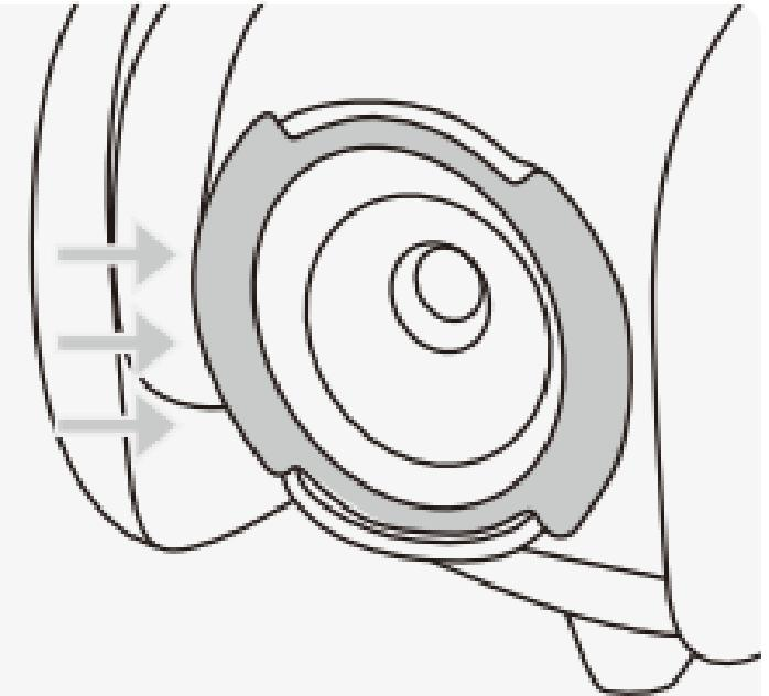
将磁环与无人机的摄像头对齐，按压中心并固定，然后按压两侧，确保双面胶完全贴合。
