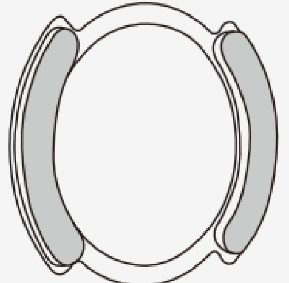
撕掉磁环两侧的胶带保护膜，露出双面胶。
