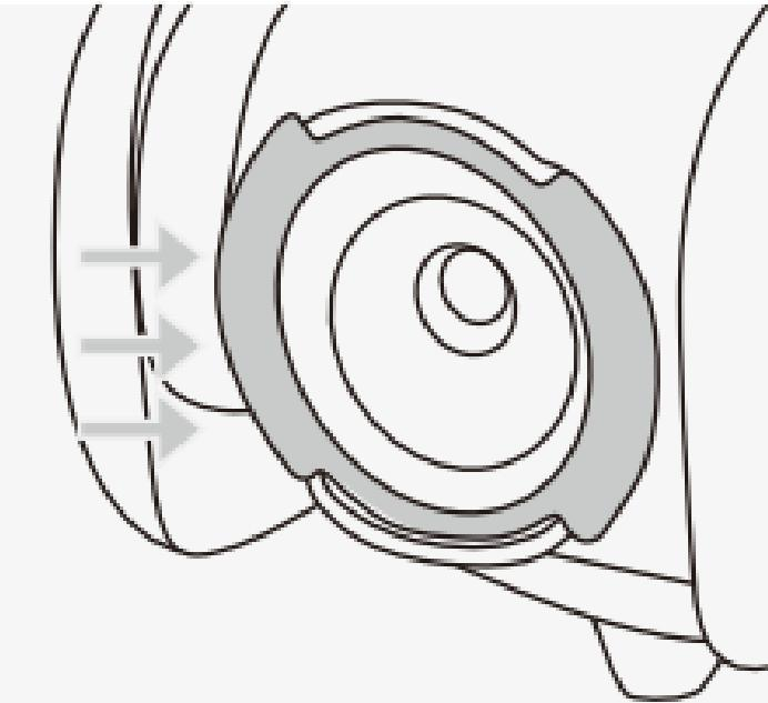
Alinea el anillo magnético con la cámara del dron, presiona firmemente para centrarlo y fijarlo, y asegúrate de que la cinta esté completamente adherida presionando ambos lados.
