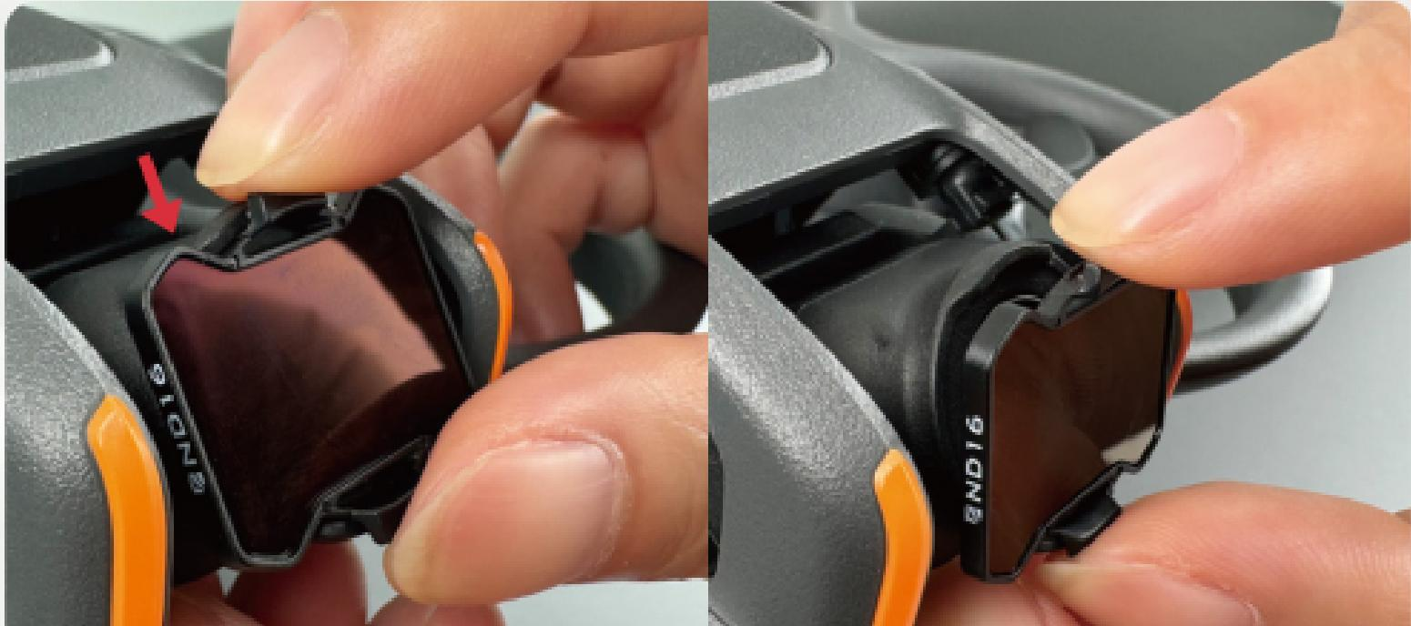
③Drücken Sie nach unten und dann nach außen, sodass sich die Laschen oben am Filter aus den Schlitten an der Kamera lösen können.
