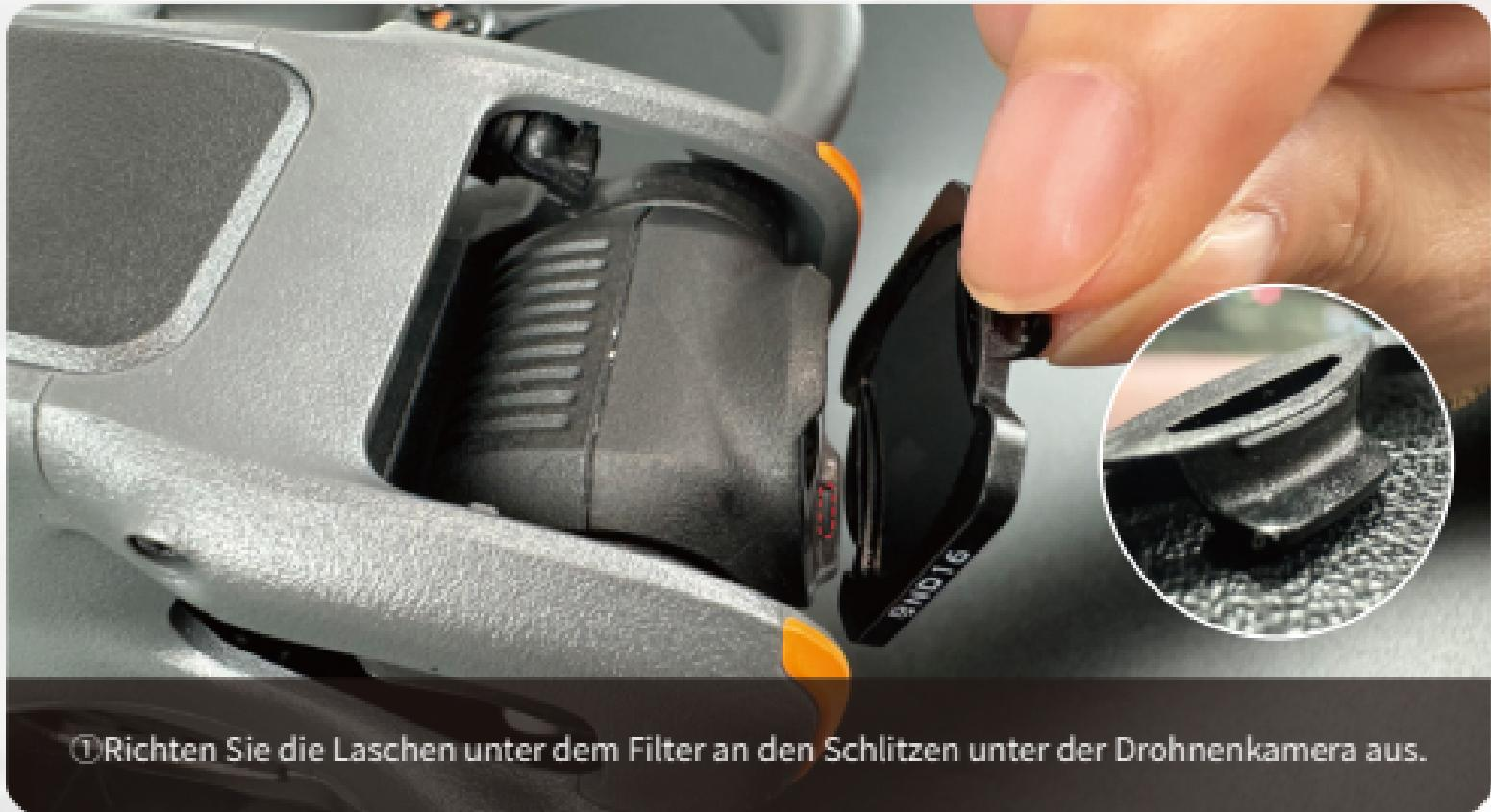
① Richten Sie die Laschen unter dem Filter an den Schlitten unter der Drohnenkamera aus.
