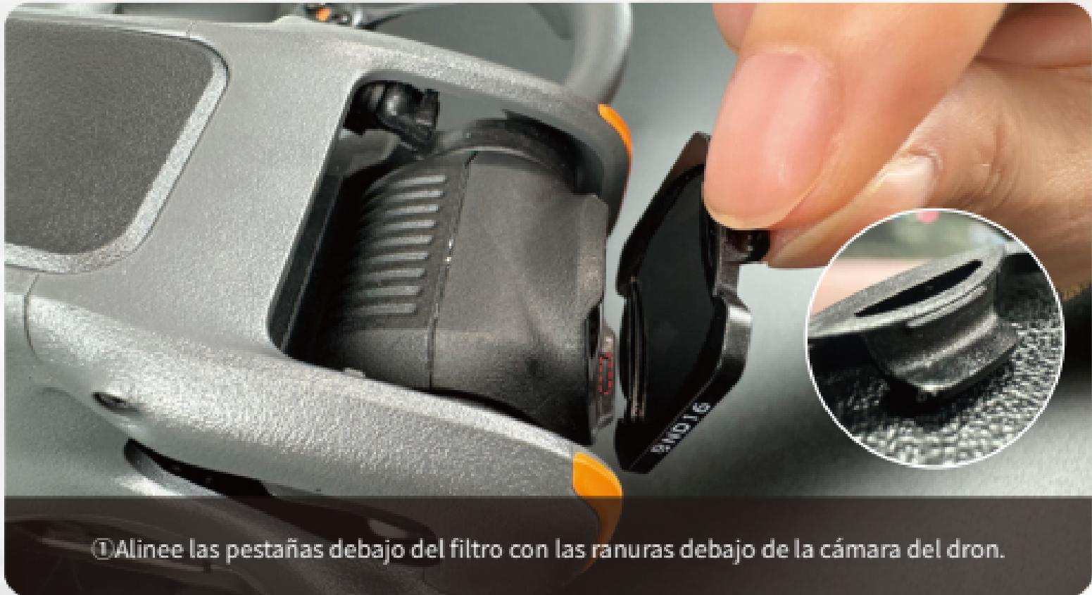
① Alinee las pestañas debajo del filtro con las ranuras debajo de la cámara del dron.
