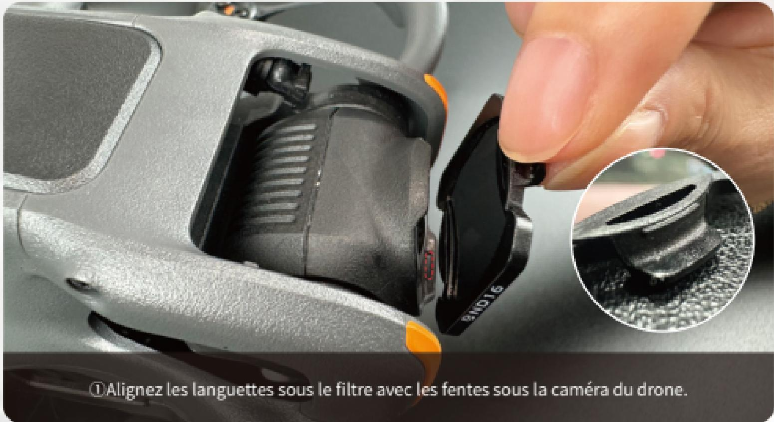
① Alignez les languettes sous le filtre avec les fentes sous la caméra du drone.
