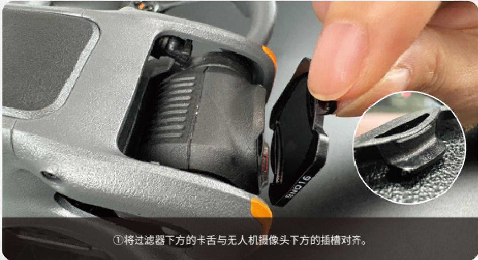
①将过滤器下方的卡舌与无人机摄像头下方的插槽对齐。
