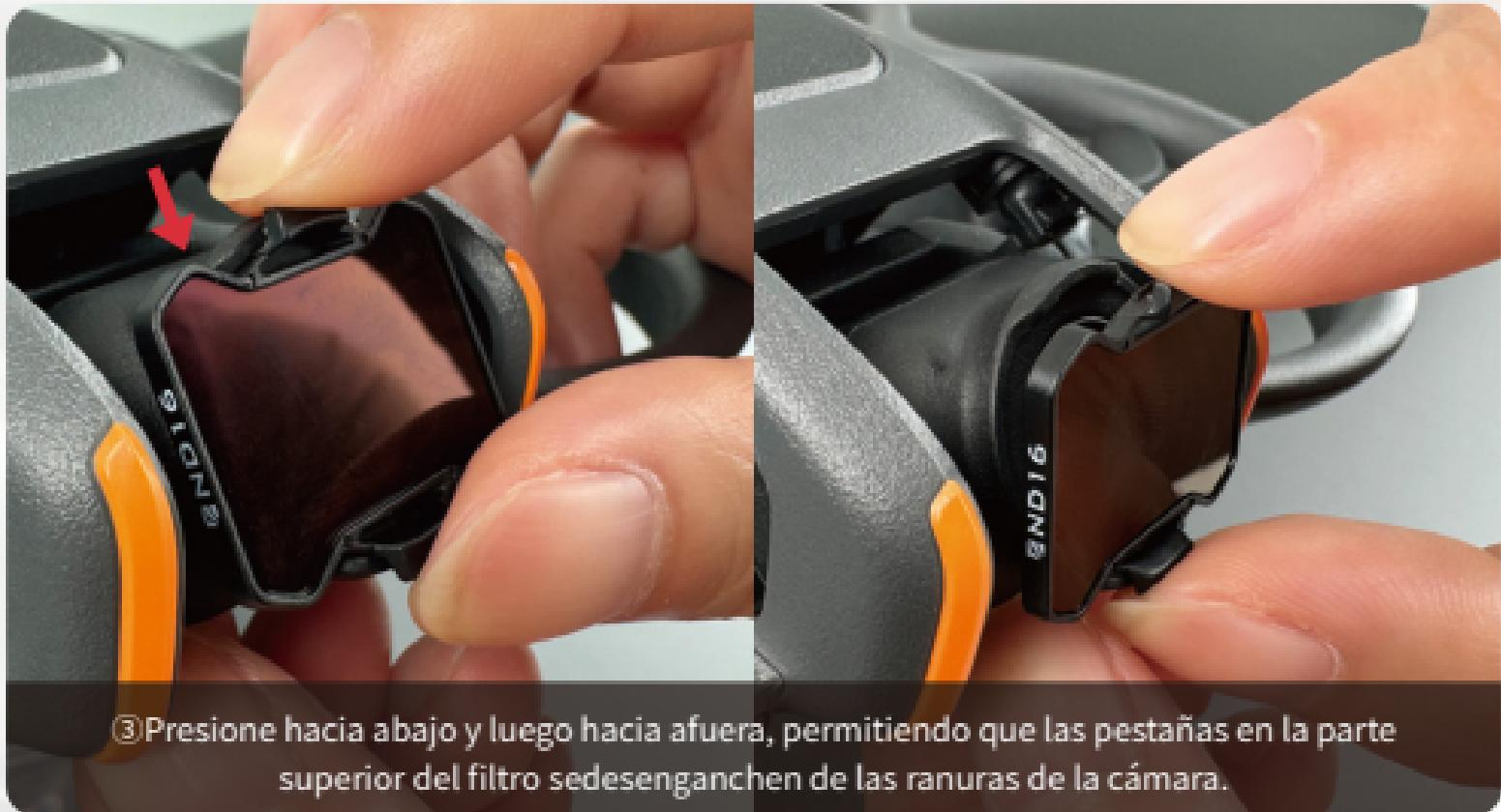
③Presione hacia abajo y luego hacia afuera, permitiendo que las pestañas en la parte superior del filtro se desenganchen de las ranuras de la cámara.
