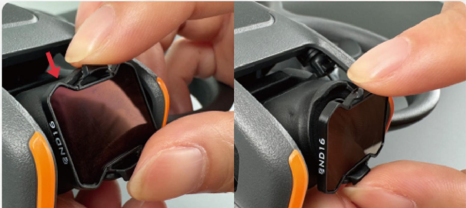
③Appuyez vers le bas puis vers l'extérieur, permettant aux languettes situées en haut du filtre de se dégager des fentes de l'appareil photo.
