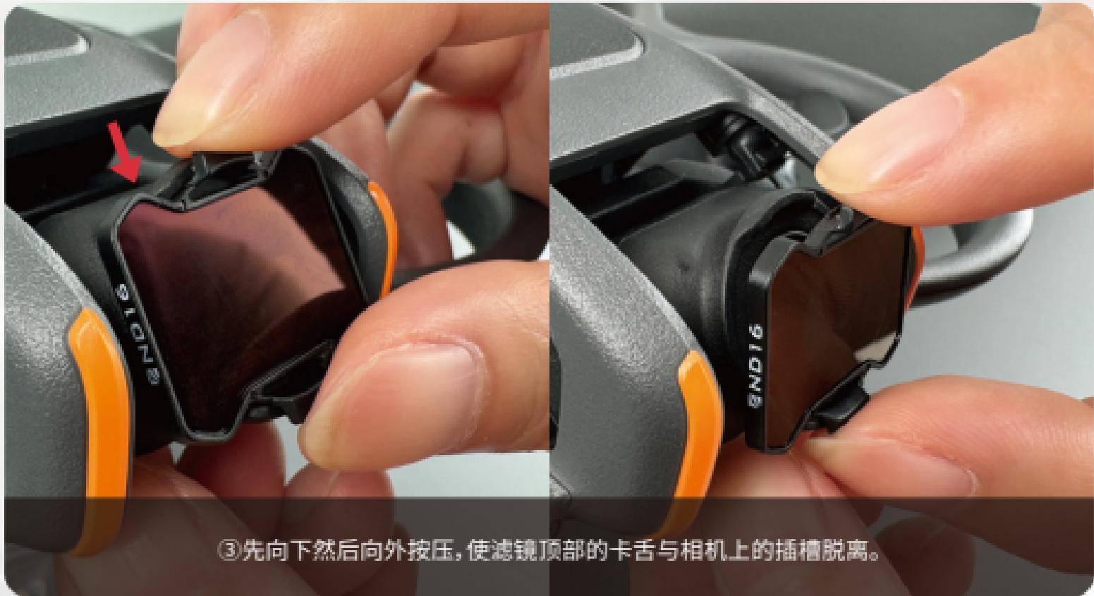
③先向下然后向外按压，使滤镜顶部的卡舌与相机上的插槽脱离。
