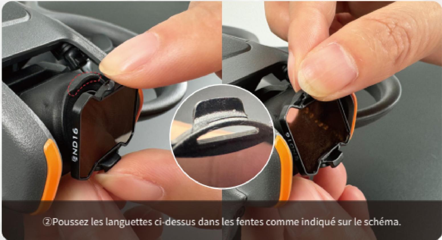
②Poussez les languettes ci-dessus dans les fentes comme indiqué sur le schéma.
